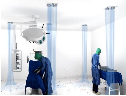
Les bouches d'aération traditionnelles protègent uniquement la zone exactement sous le flux d'air
